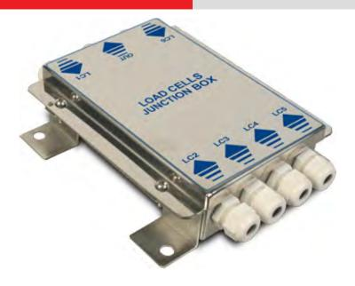
Edelstahl Anschlusskasten, Schutzart IP65, ausgestattet mit einer Platine zum Anschluss und Abgleich von 4 oder 6 Wägezellen. Schraubare Klemmleisten für einen einfachen Anschluss der Messleitungen und Abgleichswiderstand für einen genauen und zuverlässigen Eckenabgleich.
